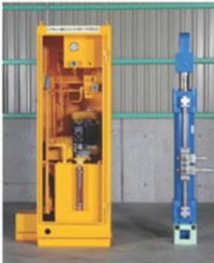
①レスキュー油圧ユニットをシリンダ付近に置く。
