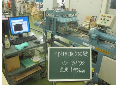
引抜き試験を実施し、竹補強材の引抜き特性を確認しています。
