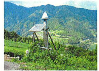
●GPSによる地すべりの移動量の観測
