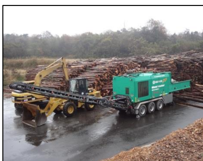
1時間あたり100tという世界最高レベルの処理能力の移動式木質系破砕機を導入し、間伐材等の破砕に使用
