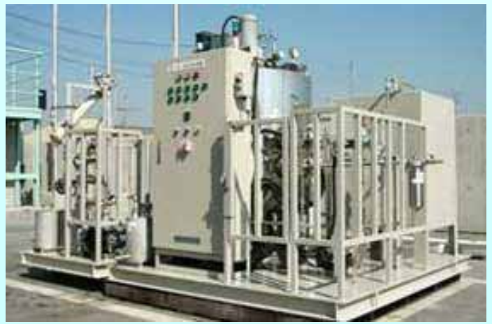
バイオディーゼル燃料製造施設(愛媛県松山市) (廃食用油からバイオディーゼル燃料を製造・販売)
