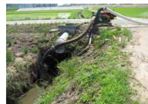
口径 150 吐出力 2.8 m 3 /分 揚程 15m 排水路末端のゲート締切で吸水位確保
