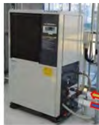
図1. 冷温水制御・循環装置
