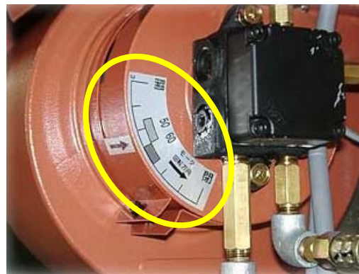
エアシャッターの調整部
