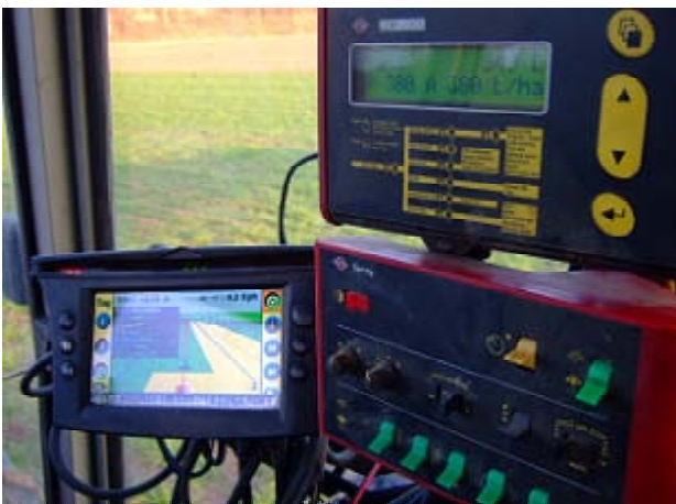
GPS・スプレイヤー車速連動モニター
