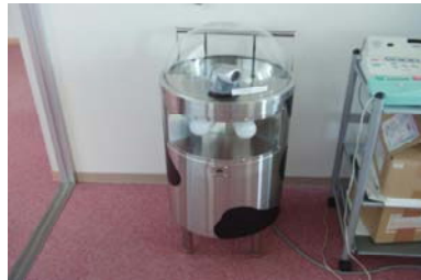
牛舎遠隔監視ロボット ロボットは高さ1mほどの円筒形で、上部にズームも可能なレンズ、マイク、照明が取り付けられている。
