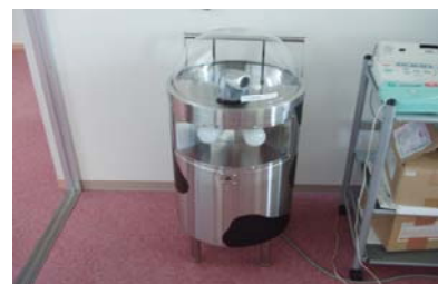
牛舎遠隔監視ロボット ロボットは高さ1mほどの円筒形で、上部にズームも可能なレンズ、マイク、照明が取り付けられている。
