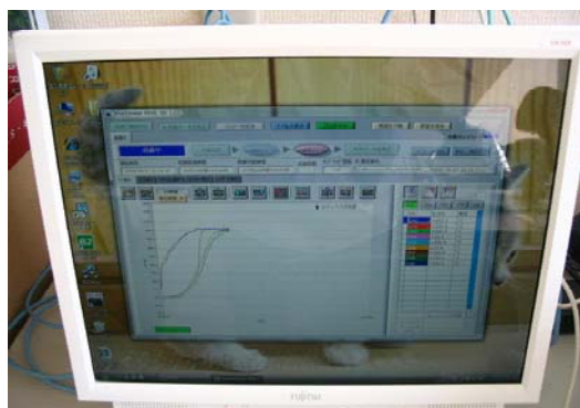
高圧釜のパネルモニターと同様の画面が事務室内のパソコンにもグラフ表示されデータも随時更新、蓄積されている。
