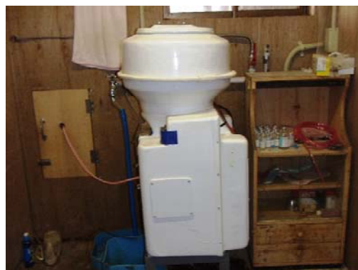
自動ほ乳機（ほ乳ロボット）
