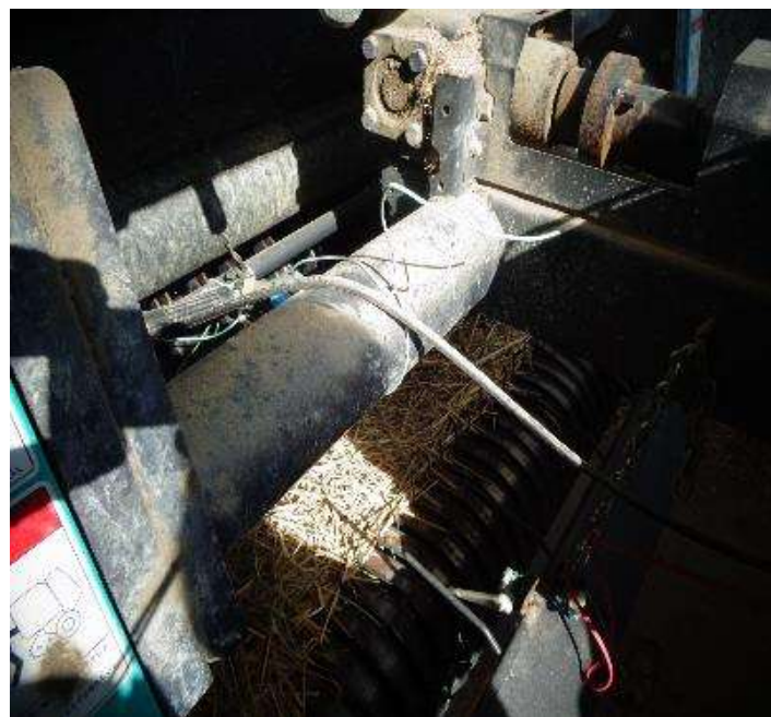
乳酸菌がロールの表面で噴霧するよう工夫
