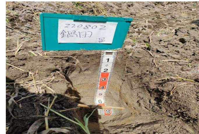
排水路の高低差がないため排水不良（逆流）
