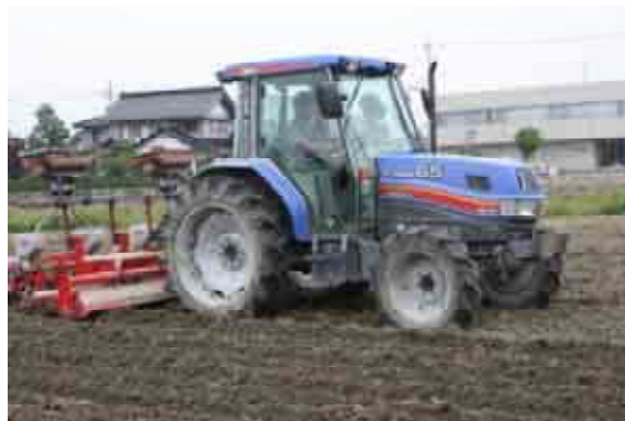
左：作業効率アップのために改良した肥料タンク。 審査においても独自の工夫が評価されました。 右：畝立て同時播種機
