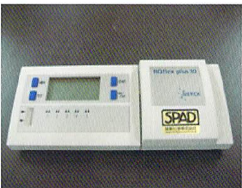
●小型反射式光度計(窒素量を現場で短時間に測定)
