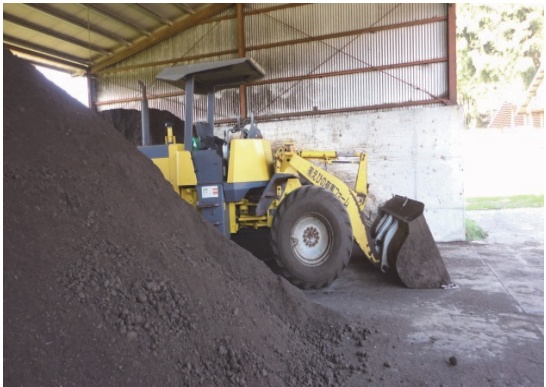
写真3 戻し堆肥と運搬用ホイールローダー
