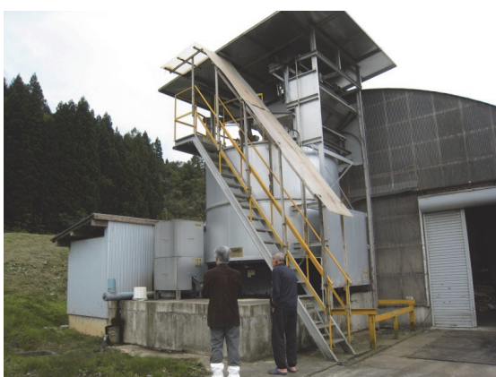
写真3 密閉型発酵装置(D19ET)
