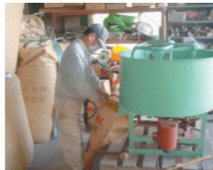
小ロットの自家配合飼料製造状況。籾米や米ぬか等の単味飼料原料投入後攪拌。
