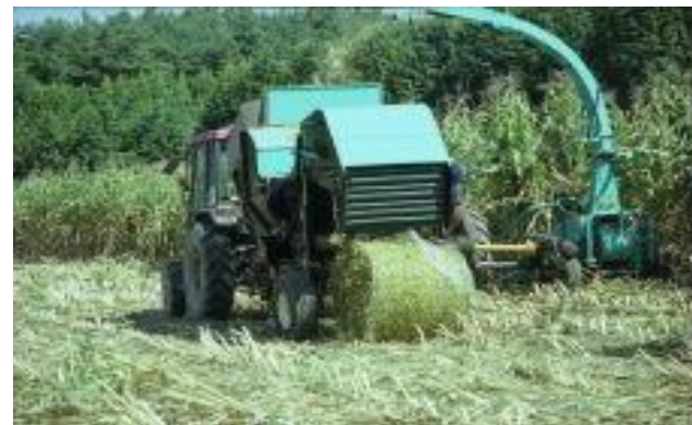
・青刈りとうもろこしのロールベール給与を可能とするために開発された「細断型ロールベアー」
