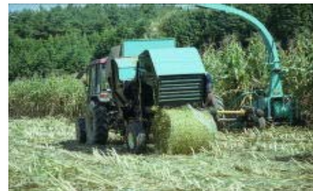
・青刈りとうもろこしのロールベール給与を可能とするために開発された「細断型ロールベアラ」
