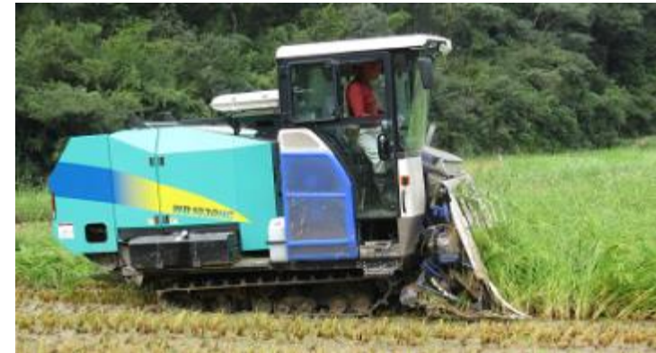
WCS用稲収穫専用機利用
