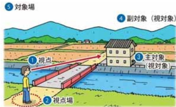
図 4-2 景観把握モデル～視点場と視対象の関係～ (参考 篠原：景観の工学的把握、『新体系土木工学 59 土木景観計画』、土木学会編，pp. 27-39，1993.)
