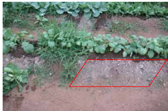
写真 - 29.2 マグホワイトと糊材のスラリーの散布による雑草抑制効果（赤枠内）
