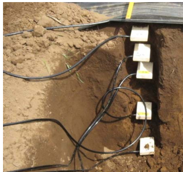
ほ場水分を測定するための 誘電式土壌水分計の事例
