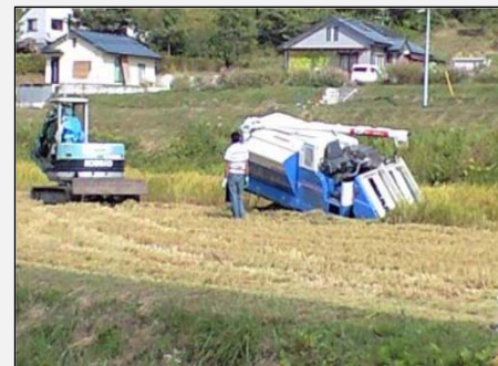
地耐力不足による機械作業への支障
