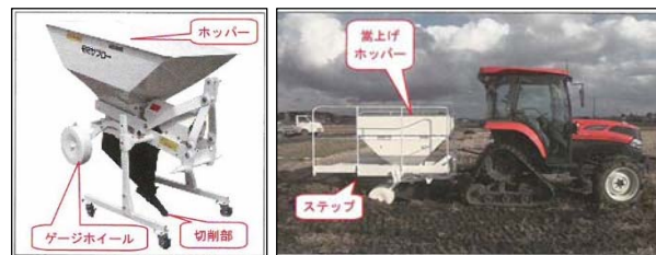
【簡易な暗渠開削充填機により補助暗渠を施工】
