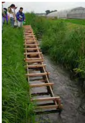
簡易な魚道での遡上試験のイメージ
