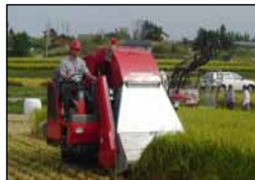
専用収穫機による 収穫、ロール形成 作業
