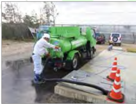
プラントから消化液(液肥)を汲み上げ
