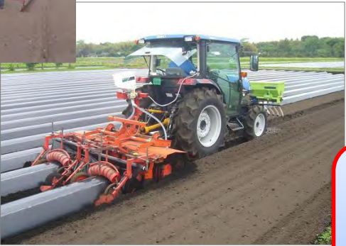
図2 肥料・薬剤の散布と畝立て・マルチの同時作業（サツマイモ）
