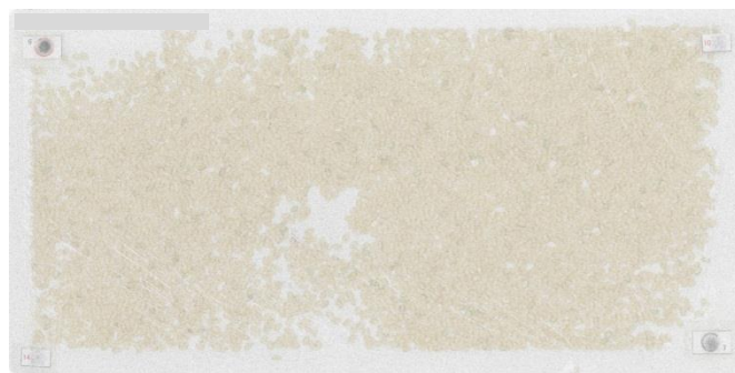
図7 中通りのほ場で生産された24年産のイメージングプレートの検出結果 (玄米中の放射性セシウム濃度 140 Bq/kg)
