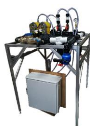
自動灌水・施肥制御装置
