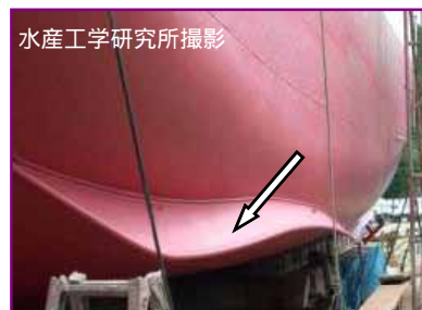
流体力学に基づくビルジキール (横揺れ防止装置)の形状変更
