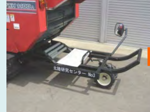
収穫機に取り付けた ロールベール運搬装置
