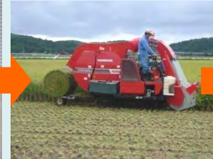
収穫しながら ロールベールを 農道付近に運搬
