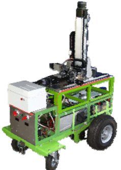
2004～2006年いちご収穫ロボット(1号機) このモデルから人視感覚色彩抽出法を実装していた。
