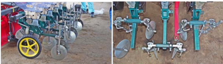
小畦立て播種装置装着図(ベース播種機:RXG-6PSE)
