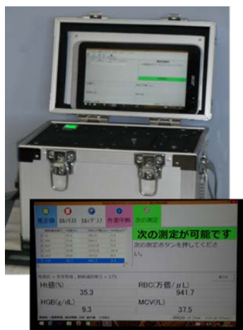
上: 装置本体と操作・データ管理用タブレットPC 下: 測定結果の表示(タブレットPC)
