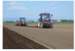
無人トラクタによる耕うんに追従する有人トラクタによる播種
