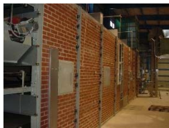
＜輻射熱を利用した乾燥工程＞
