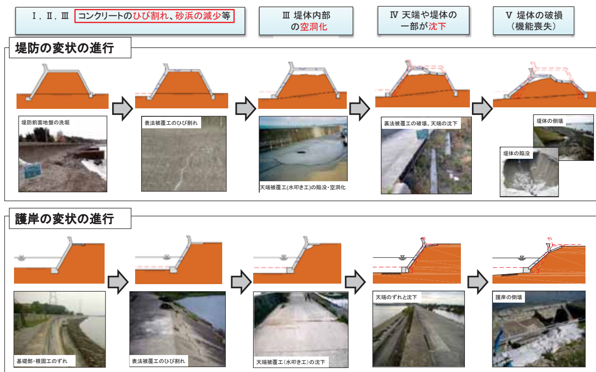
図-2.6 変状の進展の具体例
