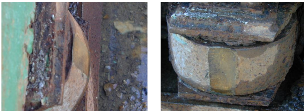
図 2.1.3 ゲートのサイドローラ部の摩耗
