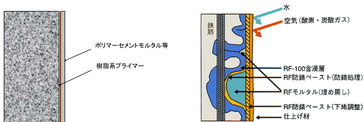
図 6-1 含浸材塗布工法の例
