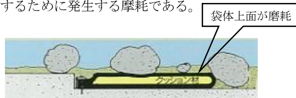
図 2.1.3 転石による袋体の摩耗の概念図
