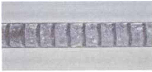
腐食度区分：腐食なし又は 0
