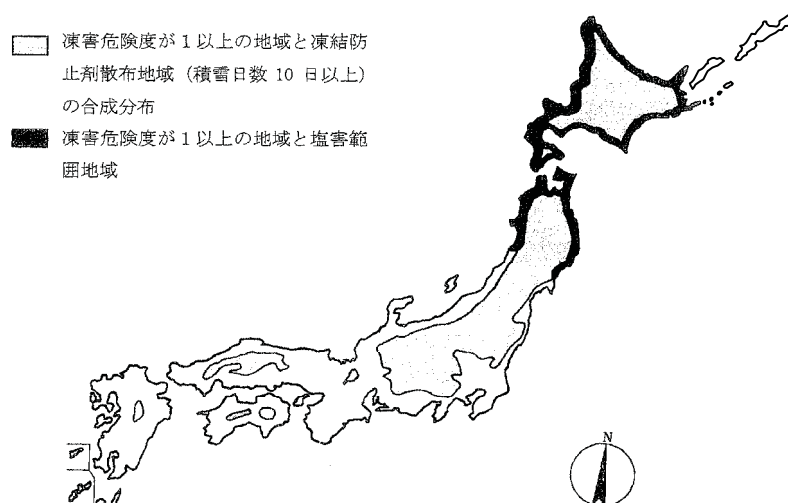
図 3. 3-40 塩害と凍害による複合劣化の可能性がある地域
