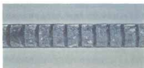
腐食度区分：腐食なし又は0
