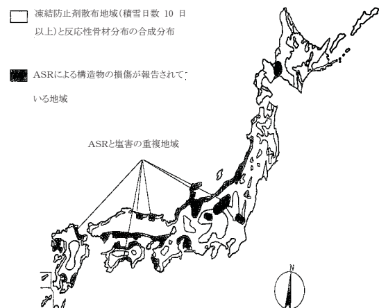
図 3.3-19 ASR 1) と塩害による複合劣化の可能性がある地域
