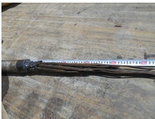
図 2-9 テンドンの破断状況
