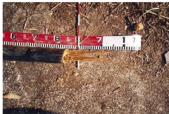
図 2-26 テンドンの腐食の事例
