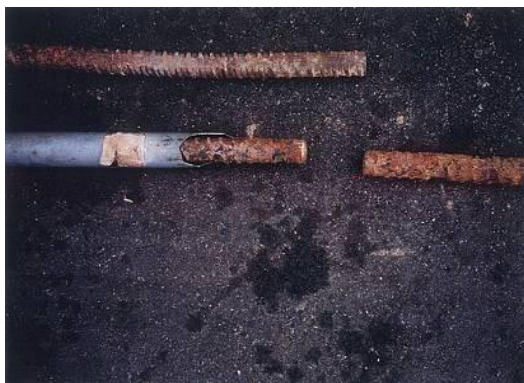
図 2-26 テンドンの腐食の事例
