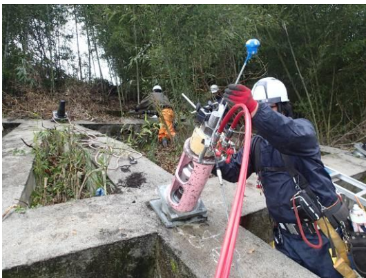
図 4-4 リフトオフ試験 (小型軽量ジャッキ使用)
