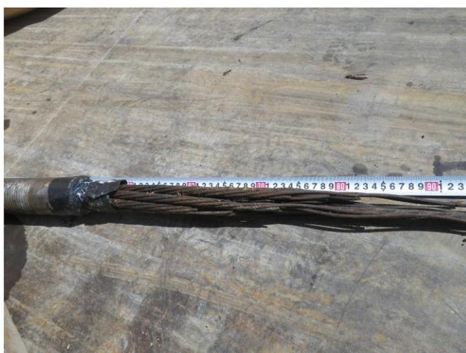
図 2-9 テンドンの破断状況
