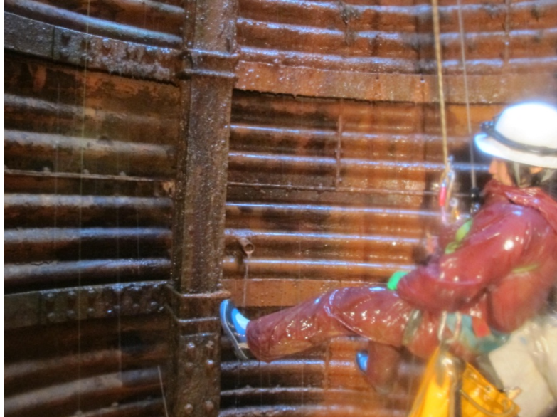
図-3 懸垂下降による詳細調査事例
