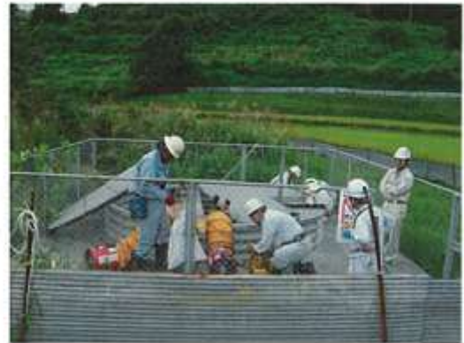
図-3 火山性ガス測定状況
