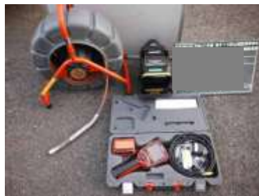
孔内カメラ測定機材
