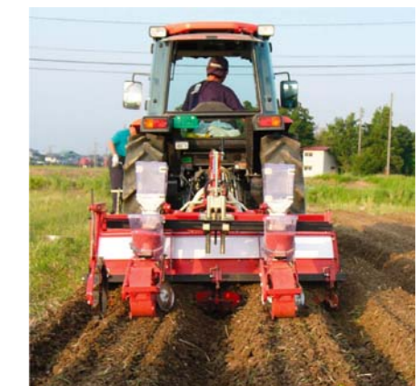
写真2 重粘土ほ場向けに開発された改良型アップカッターロータリを装備した畝立て・施肥・播種同時作業機
