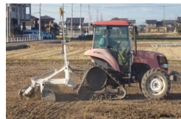
レーザーレベラー
